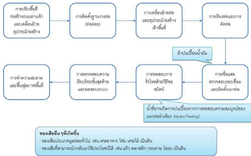
รูปที่ 2-22 แผนผังกระบวนการและแหล่งที่มาของของเสียในระยะก่อสร้างและติดตั้งแนวท่อลำเลียง
