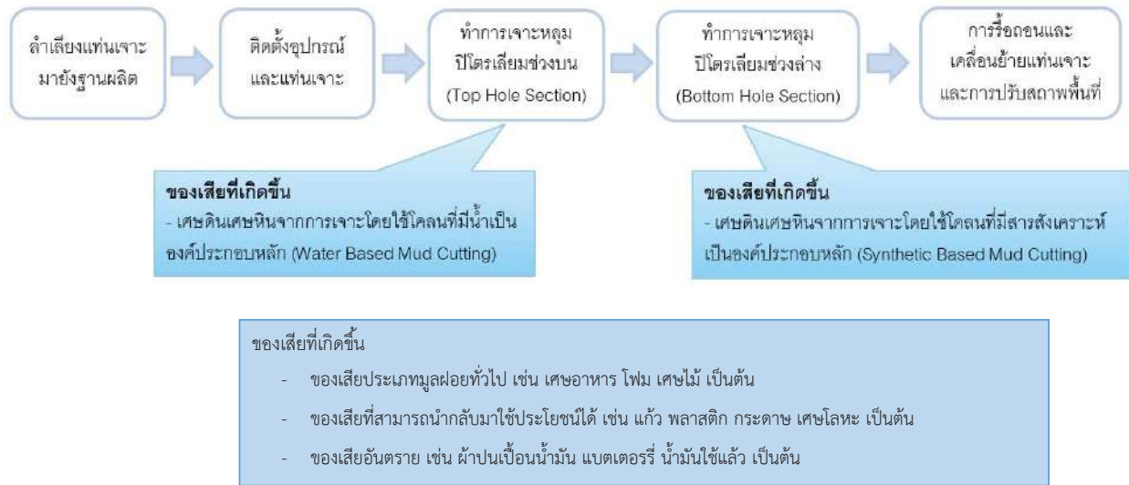
รูปที่ 2-14 แผนผังกระบวนการและแหล่งที่มาของของเสียในระยะเจาะ
