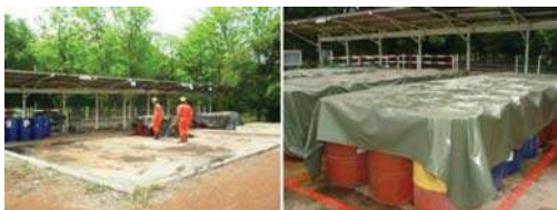
รูปที่ 3-6 ลักษณะพื้นที่จัดเก็บกากตะกอนปนเปื้อนน้ำมันจากการทำความสะอาดท่อขนส่งน้ำมัน ภายในสถานีนีผลิตลานกระบือ
